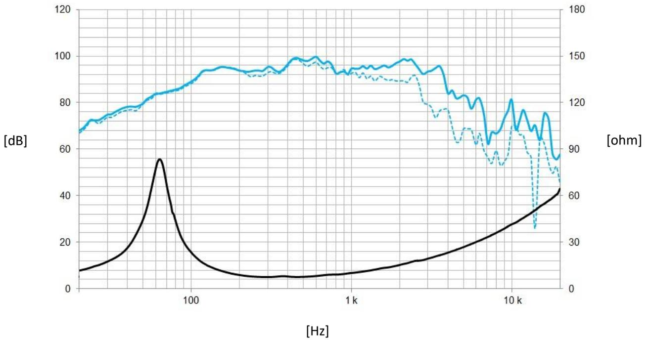
Respuesta de frecuencia medida con un altavoz colocado sobre un deflector infinito en una cámara anecoica, 1 W @ 1 m.
