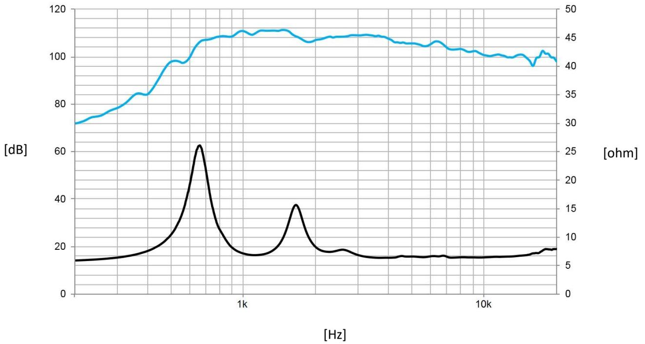
Respuesta de frecuencia medida en el eje acoplada a la bocina de IBIZA LA 210 A en cámara anecoica, 1 W @ 1 m.
