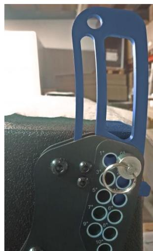
**3** Instale el bumper de vuelo FB LA 210 a la caja utilizando los pines de fijación.
